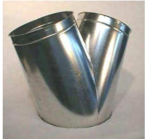
**Sattelstücke** für die Einarbeitung eines Abganges in eine bestehende Rohrleitung, Abgangswinkel 45°, komplett mit Schneideschrauben und Dichtband.
