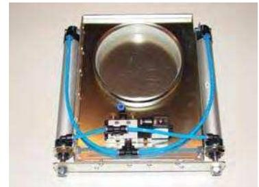
**Pneumatische Schieber Typ ASG** mit geradem Blatt zum automatischen Absperren von Rohrleitungen, beidseitig mit Bord, Schiebeteil mit pneumatischem Antrieb, komplett mit 5/2 Wegeventil mit 230 /24 V Anschluß. Luftdruck 6 – 8 bar. Ansteuerung von der Maschine oder bauseitige Steuerung.
