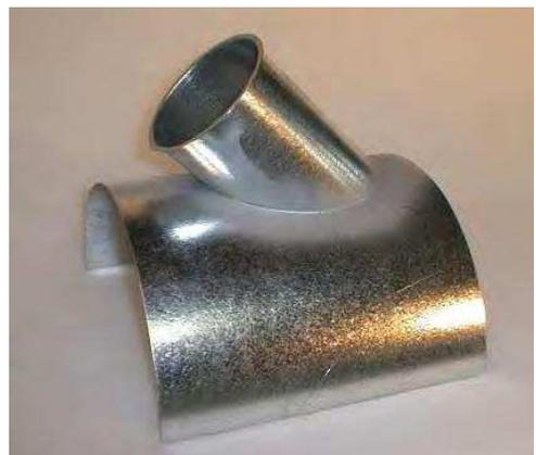
**Sammler, Langform,** mit Stutzen, Stutzenlänge 90 mm, mit Bord, Hauptdurchmesser und Abgangsdurchmesser frei wählbar, zum Anschluß von mehreren eng beieinander liegender Absaugstellen.
