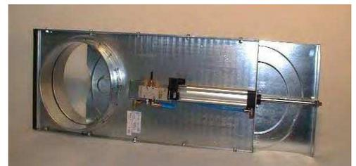
**Elektrische Schieber Typ ASM** zum automatischen Absperrn von Rohrleitungen, beidseitig mit Bord, Schiebeteil mit 230 V Linearmotor, incl. 0,5 m Anschlußkabel. Ansteuerung von der Maschine oder von bauseitiger Steuerung.
