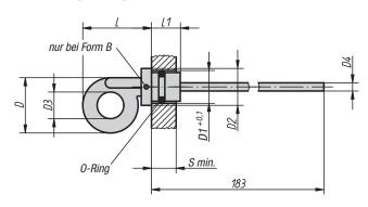
Form C ohne Entlüftungsbohrung
